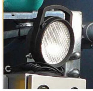
Manyetik dirsek üzerinde çalışma lambası
